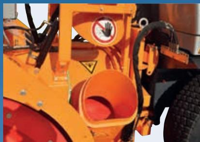
**Cheminée d'éjection montée directement sur le carter de la turbine d'éjection.**
