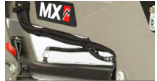
Die Hydraulikschläuche und der Kabelbaum aus Polyurethan passen diskret unter den Arm des Frontladers. Sie sind gut geschützt, bleiben sauber und leicht zugänglich.
