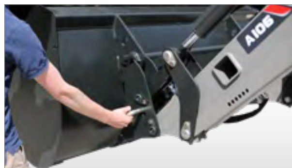
Schnellwechselrahmen mit automatischer Verriegelung. Entriegelungsgriffe sind von beiden Seiten des Rahmens aus zugänglich.
