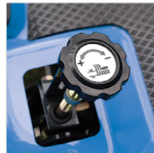
PRÄZISE SCHNITTHÖHENEINSTELLUNG Zentrales Einstellrad
