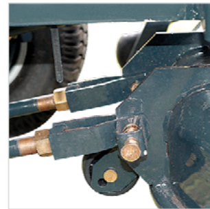
QUICK-FIX-SYSTEM Schnelle Montage und Demontage des Mähwerks
