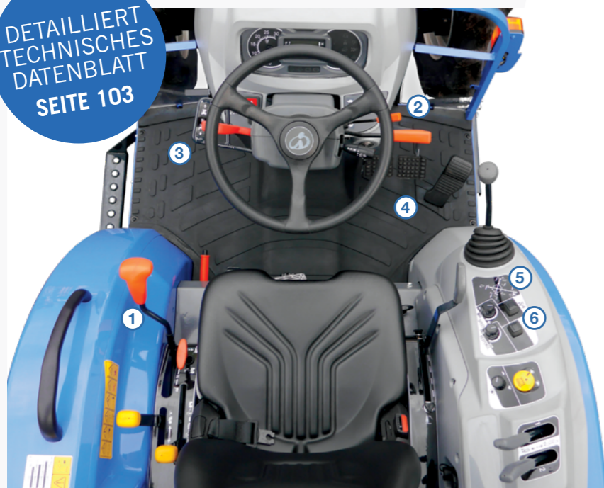
Geschwindigkeitsbereichwahlhebel (1), Hi-Low-Steuerung, Power Shuttle (3), Vorwärtsfahrpedal (4), Tempomat (5), Geschwindigkeitsspeicherfunktion zur Rückkehr zur Anfangsgeschwindigkeit (6).
