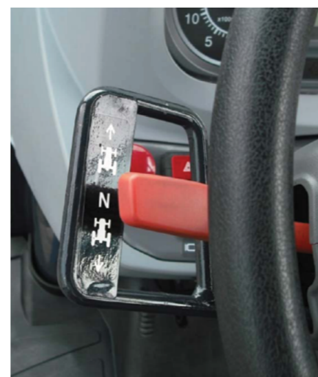
Geschwindigkeitsbereichwahlhebel (1), Hi-Low-Steuerung, Power Shuttle (3), Vorwärtsfahrpedal (4), Tempomat (5), Geschwindigkeitsspeicherfunktion zur Rückkehr zur Anfangsgeschwindigkeit (6).
