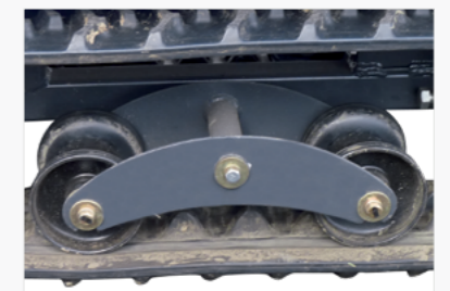
RAUPENKETTEN AUF DREHGESTELLEN MIT AUSGLEICHFEDERN
