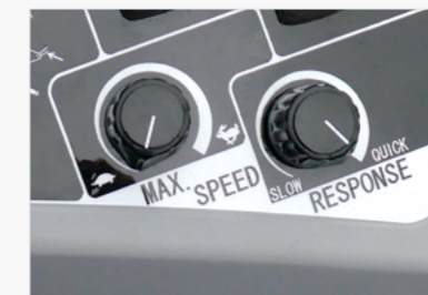
2 POTENTIOMETER ZUR GESCHWINDIGKEITSREGELUNG
