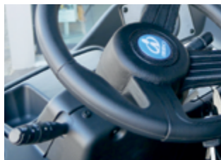
Multifunktionshebel für Beleuchtung, Blinker, Licht etc
