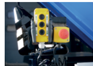
Bedienung der Hebevorrichtung (außerhalb des des Fahrzeugs)
