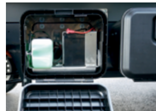
Kofferraum für eine zusätzliche Batterie für. Kabinenbeleuchtung und Armaturenbrett und B Scheibenwaschbehälter
