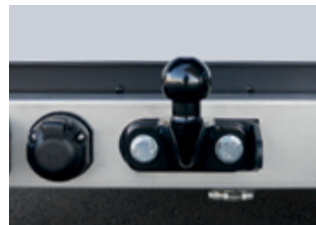
Anhängerkupplung und elektrische Steckdose Standard (außer bei der Version mit Abfallcontainer)
