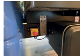
Der Not-Aus-Knopf befindet sich hinter der Kabine links (1)
