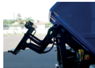
Vorrichtung zum Anheben von Abfallbehältern (120, 240 oder 360 Liter)
