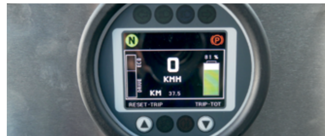
Tacho mit LCD-Farbbildschirm: Batterieladung, Geschwindigkeit, Kontrollleuchten, zurückgelegte Strecke, etc... (1)
