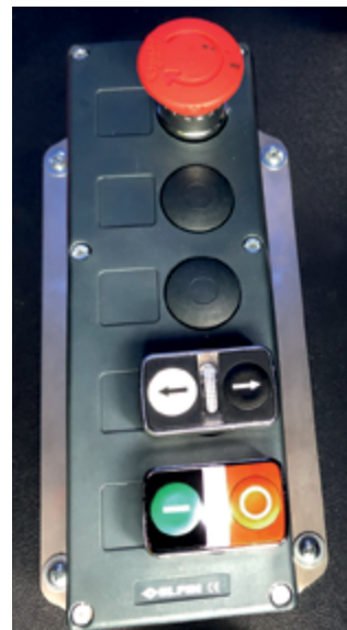
Bedienelemente für das Kippen der Abfallbehälter in der Kabine
