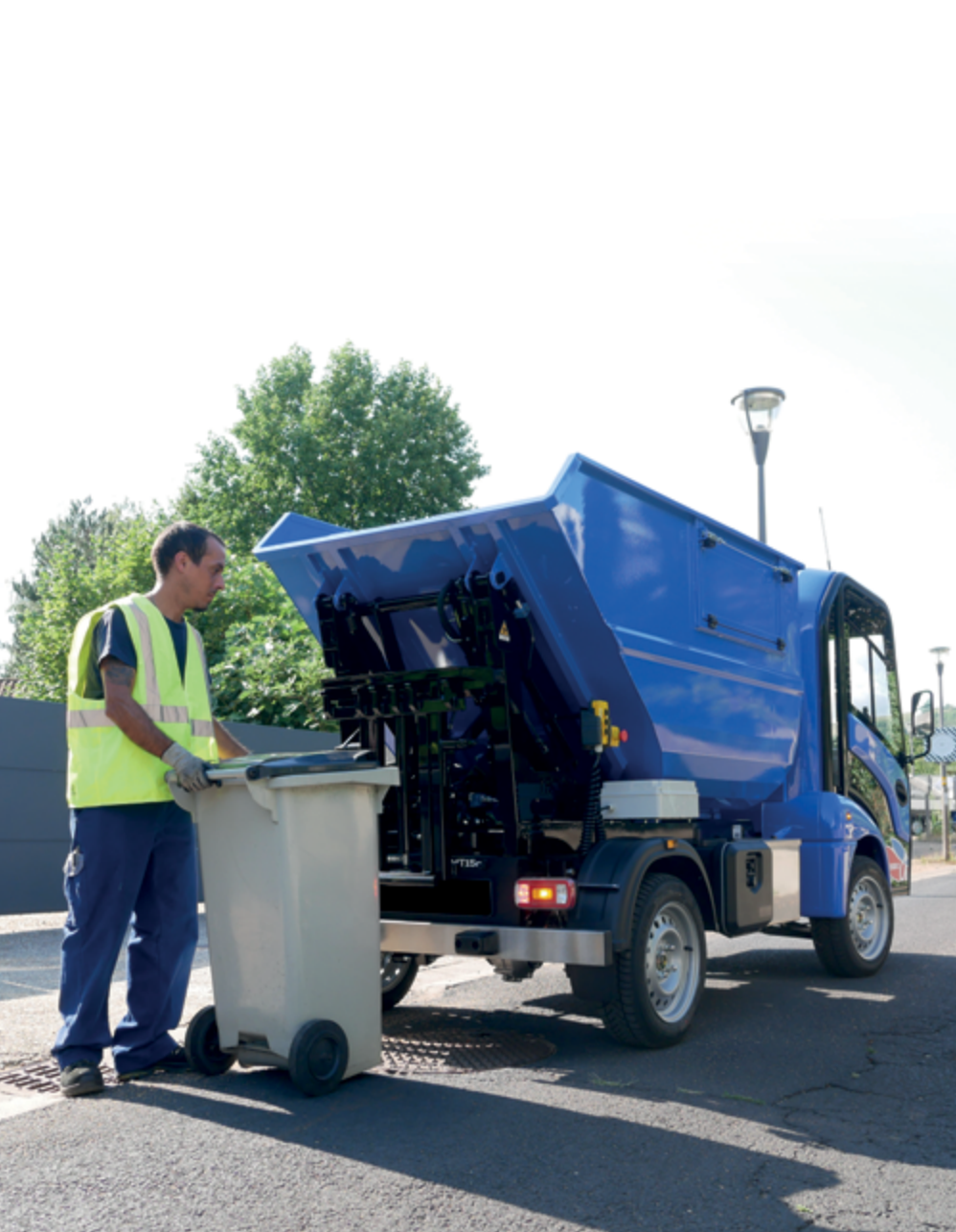
Vorrichtung zum Anheben von Abfallbehältern (120, 240 oder 360 Liter)
