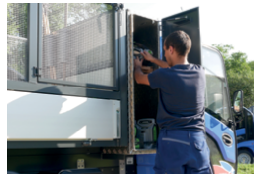
Kofferraum für eine zusätzliche Batterie für. Kabinenbeleuchtung und Armaturenbrett und B Scheibenwaschbehälter
