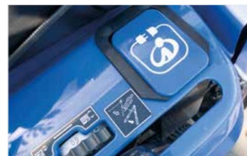
COMPARTIMENT CABLE DE CHARGE ET RÉGLAGE DE HAUTEUR DE COUPE
