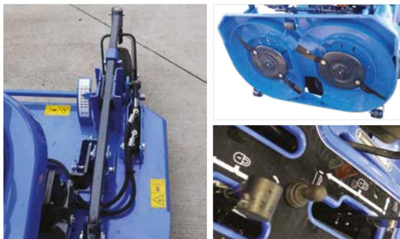
Le plateau de coupe 1,52 m est équipé de deux disques avec chacun deux couteaux rétractables qui s'escamotent en cas d'obstacles. Ce système permet de protéger la transmission entièrement mécanique (pas de courroie) qui est animée par deux boîtiers renvoi d'angle en fonte extrêmement robustes.
