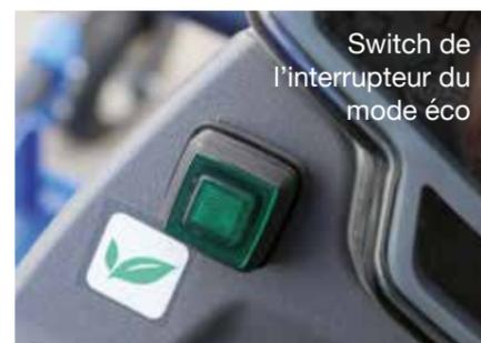
Switch de l'interrupteur du mode éco
