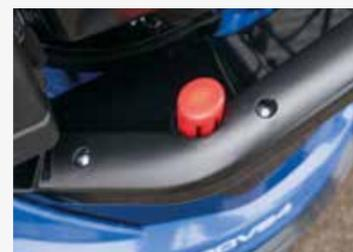
RÉGLAGE CENTRALISÉ DE LA HAUTEUR DE COUPE
