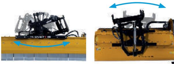
Bei ungleichmäßigem Untergrund sorgen großzügige Pendel- und Lenkbewegungen für optimale Bodenpassung.
