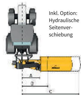
Inkl. Option: Hydraulische Seitenverschiebung
