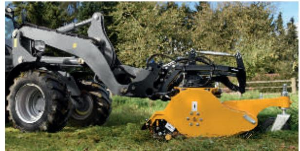
Virtueller Zugpunkt- Ein Müthing Patent: Das Mulchgerät wird mit geringem Rollwiderstand gezogen anstatt geschoben und folgt so jeder Bodenkontur perfekt.
