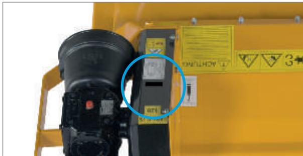
Keilriemenspannung immer im Blick: Keilriemenschutz mit Kontrollöffnung.
