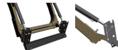
**WERKZEUGHALTERRAHMEN FÜR C1/C1S MIT PRÄDISPOSITION FÜR TRC 500 PALETTENGABEL UND BALLENGABEL**
