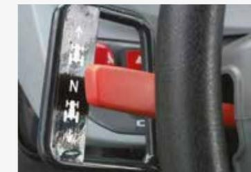
**LASTSCHALTWENDEGETRIEBE AM LENKRAD**
