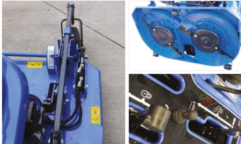
Das 1,52 m große Mähwerk ist mit zwei Scheiben mit jeweils zwei einziehbaren Messern ausgestattet, die bei Hindernissen einklappen. Dieses System schützt den vollständig mechanischen Antrieb (kein Riemen), der von zwei extrem robusten Winkelgetrieben aus Gusseisen angetrieben wird.
