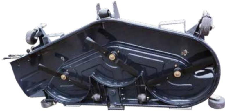
Die Serie TG6407 DCE kann mit zwei Mähwerken ausgestattet werden (Breite 1,83 oder 1,52 m). Das 1,83 m-Modell kann schnell und mühelos an- und abgekuppelt werden, indem es einfach über das Mähwerk gerollt wird.
